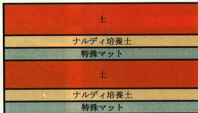
図 1. 多層式培養土システム断面図
