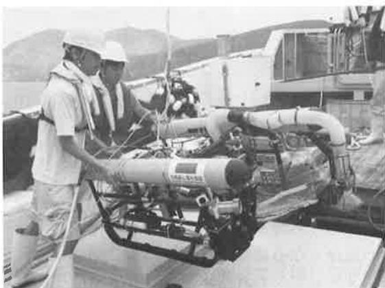
図-3 遠隔操作無人潜水艇(ROV)
