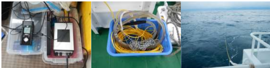
図3 曳航式水中音ステレオモニター装置“Towed Aquafeeler”（(株)アクアサウンド製）
