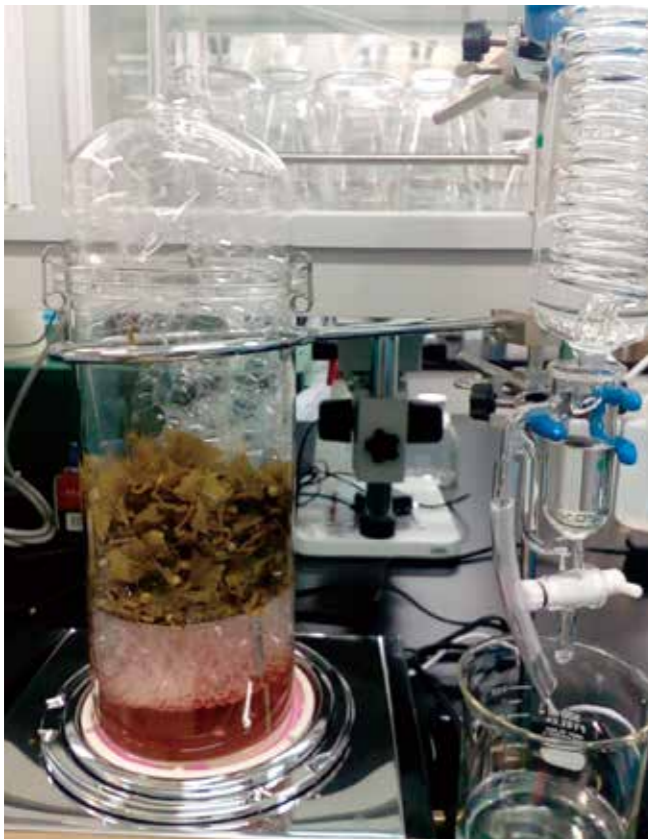
写真4: 水蒸気蒸留装置に供されるヤマクニブー
