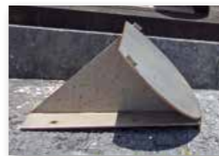
時刻を正確に測るため、傾斜角度を変更する
