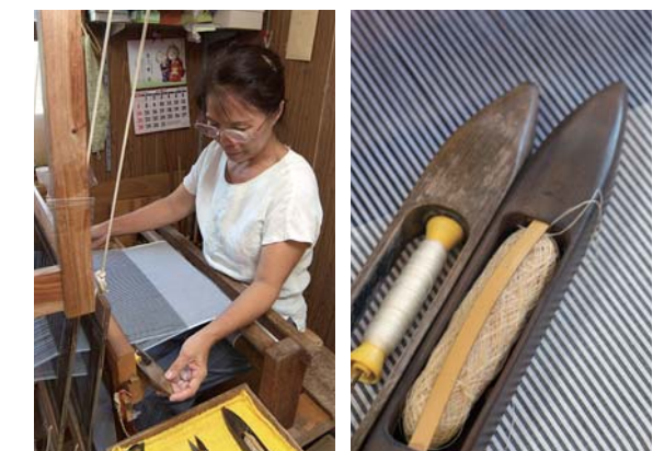
右) 緯糸を巻き込んだ杼(ひ)。左は化学繊維、右は苧麻の糸 左) 織り方は八重山上布とほぼ同じ
