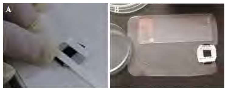
図23. A: SEM用ステージ作成。1円硬貨大のアルミ板にSEM用両面テープを貼り、さらに上部と下部に耐水紙の帯を貼る（アルミ板や耐水紙等に油脂が付かないようゴム手袋を着用して行う; B: SEM標本作成用プラスチックシート、実体顕微鏡下で骨片の載っているスライドガラスとSEM用ステージを同時に移動するためのシートで、高さ調節のためのスライドガラスの上に骨片の載っているスライドガラスを載せる。
